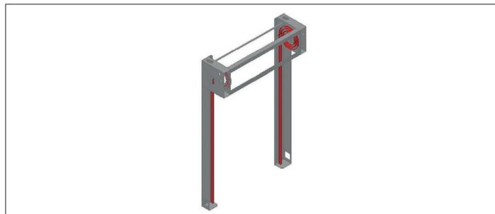
1. Убедитесь в правильности размеров проема, установите одну стойку к проему (данную операцию следует выполнять по меньшей мере трем работникам). Выставьте уровень, и закрепите верхнюю и нижнюю части стойки распорными болтами. Установите вторую стойку на необходимом расстоянии, не закрепляя ее.
