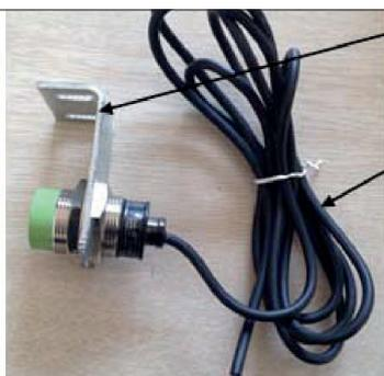
1. Место установки крепежного кронштейна датчика приближения.
